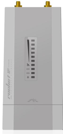
**C AirSync**, базовые станции используют общий источник времени, используя встроенный приемник GPS. Для синхронизации нужно одно устройство настроить как мастер синхронизации (Master или ведущее устройство), а другие настроить в режиме Slave (ведомое устройство). После настройки ведущее и ведомые устройства синхронизируют свои циклы передачи и приема данных и будут передавать и принимать данные в одно и то же время.
