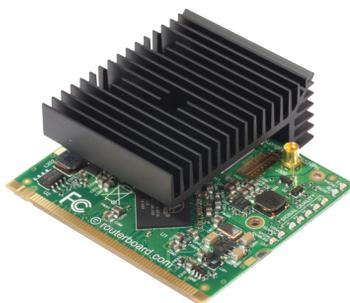
Также R5SHPn имеет один разъем MMCX и девять светодиодных индикаторов.
